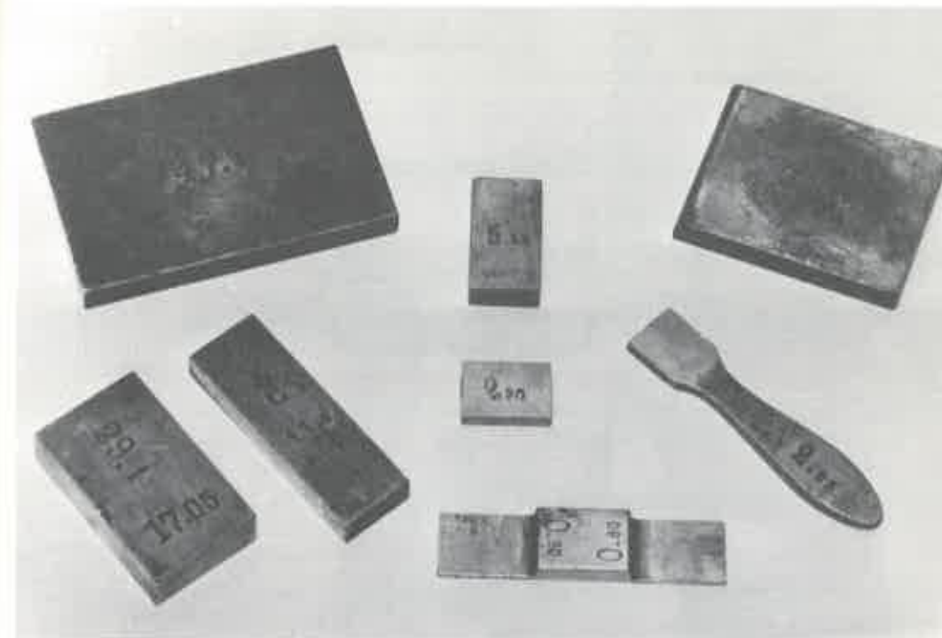
Figur 1 Parallelepipediska mätblock, passbitar av stål, en för varje måttvärde, som förekom vid vapenfabriker vid tillverkningen av vissa delar till gevär. Dessa passbitar och stickmått är de äldsta bevarade från Gevärsfaktoriet i Eskilstuna och torde vara från tiden omkring 1890. (Ovan). Instrument använda vid besiktning av 1867/89 års gevär. (Till höger).
